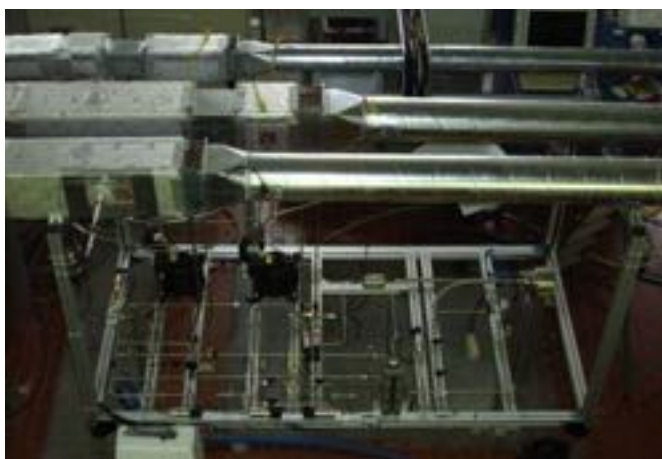
Impianto sperimentale per lo studio della \text{CO}_2 utilizzata come refrigerante
