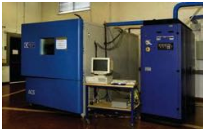
Ciclatore e camera climatica per prove di caratterizzazione e vita di batterie
