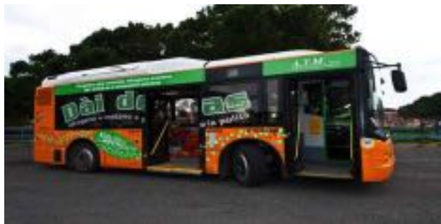
Progetti Mhy-bus, 1° autobus alimentato con miscela \text{CH}_4\text{-H}_2 in servizio di linea a Ravenna dal 2013
