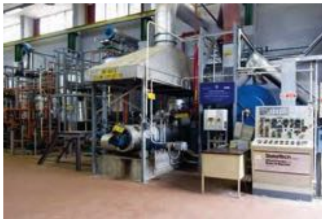
Bioraffineria: pretrattamento di biomasse tramite Steam Explosion e fermentatori
