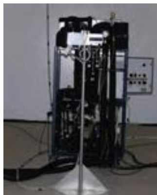
Calorimetro per la caratterizzazione di pompe di calore prototipali e commerciali, in collaborazione con l'industria italiana
