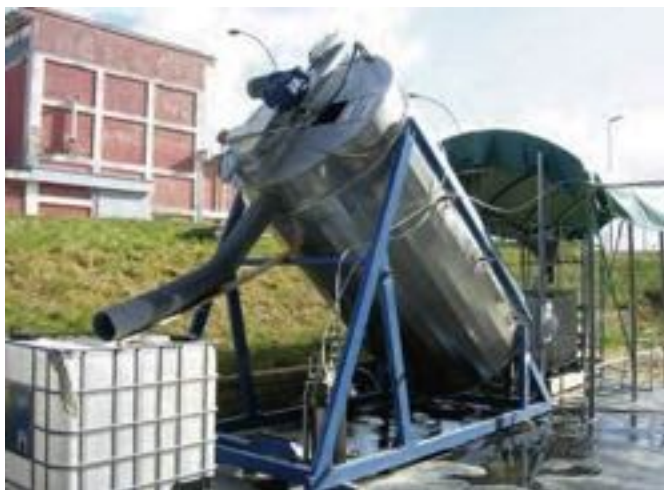
Processi biologici: digestore anaerobico mobile
