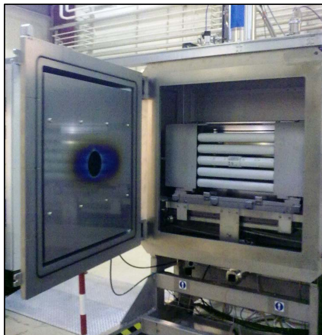
Sistema "carrello + pallet porta-substrato" dell'impianto "ENEA-2"
