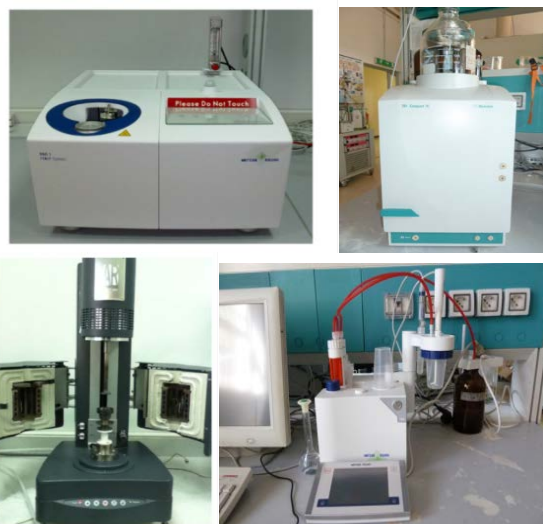
Esempi di apparecchiature presenti nel laboratorio di chimica solare ITES: dal basso a sinistra in senso orario: reometro, DSC, cromatografo ionico, microtitolatore acido/base
