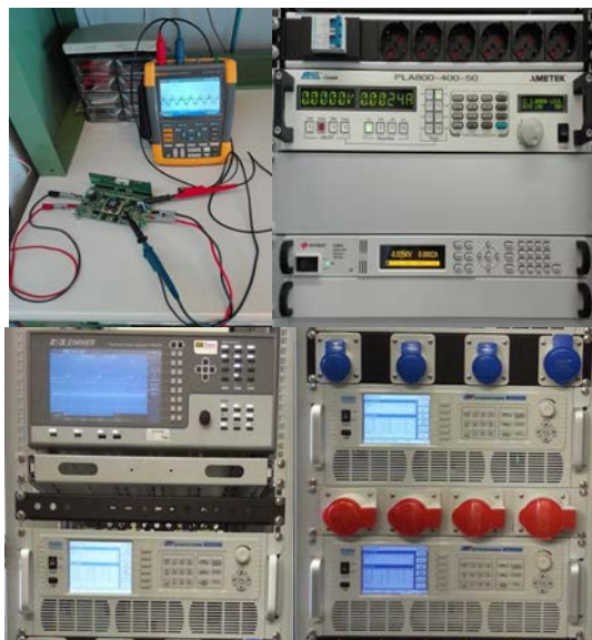
Esempi di apparecchiature presenti nel laboratorio di sistemi di conversione: oscilloscopio portatile (alto sx), generatori DC (alto dx) e generatori bipolari (basso)
