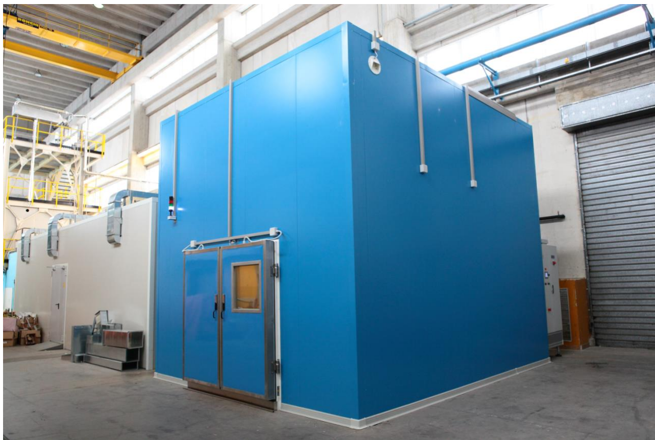
Figura 1 Camera climatica dell'impianto CALORIMETRO ENEA
