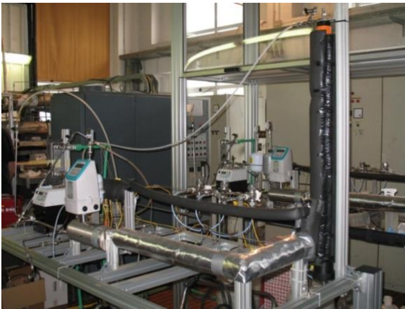
Figura 3 loop dell'impianto HETNA modificato per lo svolgimento di test su serbatoi d'accumulo termico con PCM
