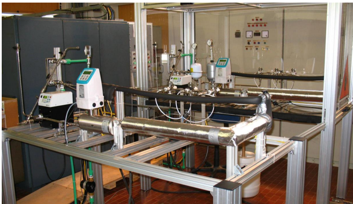
Figura 1 Circuiti gemelli dell'impianto HETNA: il circuito in primo piano è quello dedicato alle prove con fluido base, il circuito in secondo piano è quello dedicato alle prove con nanofluido e dotato di una struttura di protezione e cappa aspirante.
