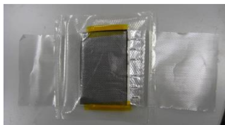
Batteria al litio ENEA da circa 75 mAh
