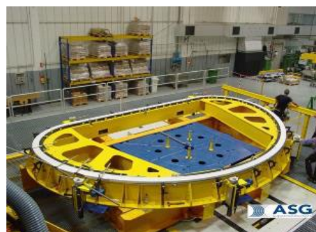
Doppio pancake sulla tavola roto-traslante della linea di avvolgimento della bobina toroidale per JT-60SA
