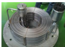
Vista del generatore di vapore a spirale piana per sistemi a piombo (LFR)
