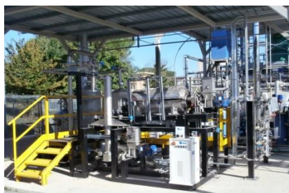
Piattaforma VALCHIRIA per lo sviluppo di un'innovativa tecnologia di gassificazione di carboni di basso rango (C.R. ENEA Casaccia)
