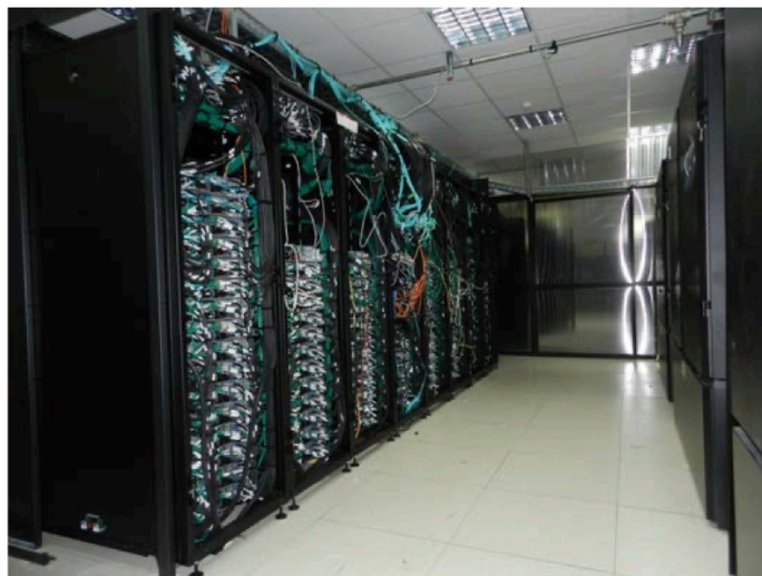
Particolare del lato posteriore del supercalcolatore CRESCO6 della linea CRESCO, installato presso il Centro Ricerche ENEA di Portici. Sono visibili gli armadi e parte dei cavi che connettono i più di 400 nodi di calcolo
