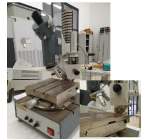
Durometro con microscopio
