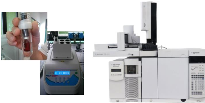
Figura 5. Campionamento reflui di condensazione e sistemi cromatografici di analisi (GCMS, HPLC)
